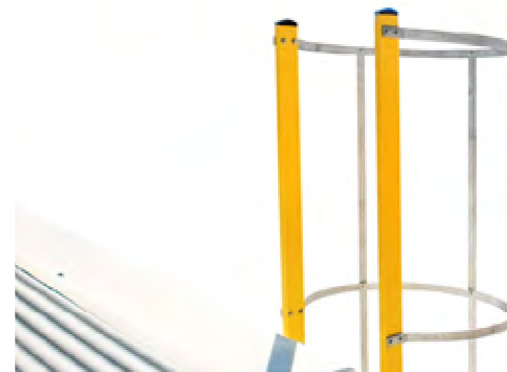
Escalera de poliéster con fibra de vidrio realizada bajo plano. La escalera queda fijada a la pared y suelo del pozo mediante escuadras de acero inoxidable.
